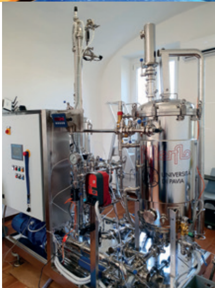
Apparato sperimentale realizzato dall'Università di Pavia per estrarre bioetanolo da materiali di scarto
